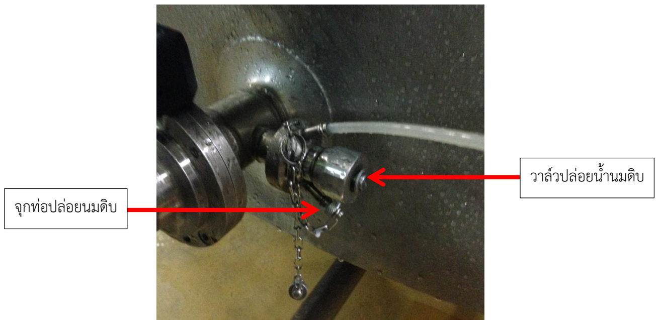
ภาพที่ 11 แสดงจุกท่อปล่อยนม และวาล์วปล่อยน้ำนมดิบ
