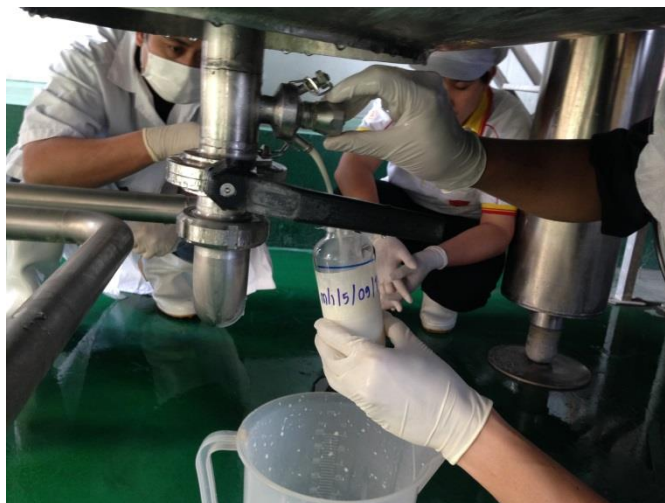
ภาพที่ 14 แสดงการเก็บตัวอย่างนมดิบจากแท่งคัมมิบชนิดที่มี Sampling Valve
