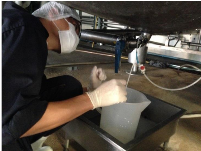
ภาพที่ 13 แสดงการเปิดจุกท่อปล่อยนม แล้วเปิดวาล์วแอลกอฮอล์เพื่อไล่แอลกอฮอล์ น้ำนมดิบ สิ่งสกปรก หรือเชื้อแบคทีเรียที่ตกค้างอยู่ใน Sampling Valve ออกไป
