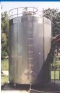
ถังเก็บน้ำนมดิบ
